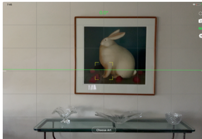
Figure 17: Herramienta de nivel activa mostrando cuadrícula, línea de nivel y visualización de ángulo
